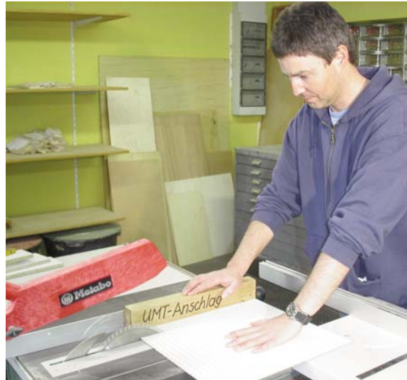
Abb. 14 Zuschneiden mit Anschlagleiste
